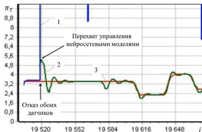
Рис 6. переходный процесс в контуре управления  $\pi_T = f(T_6^*)$
